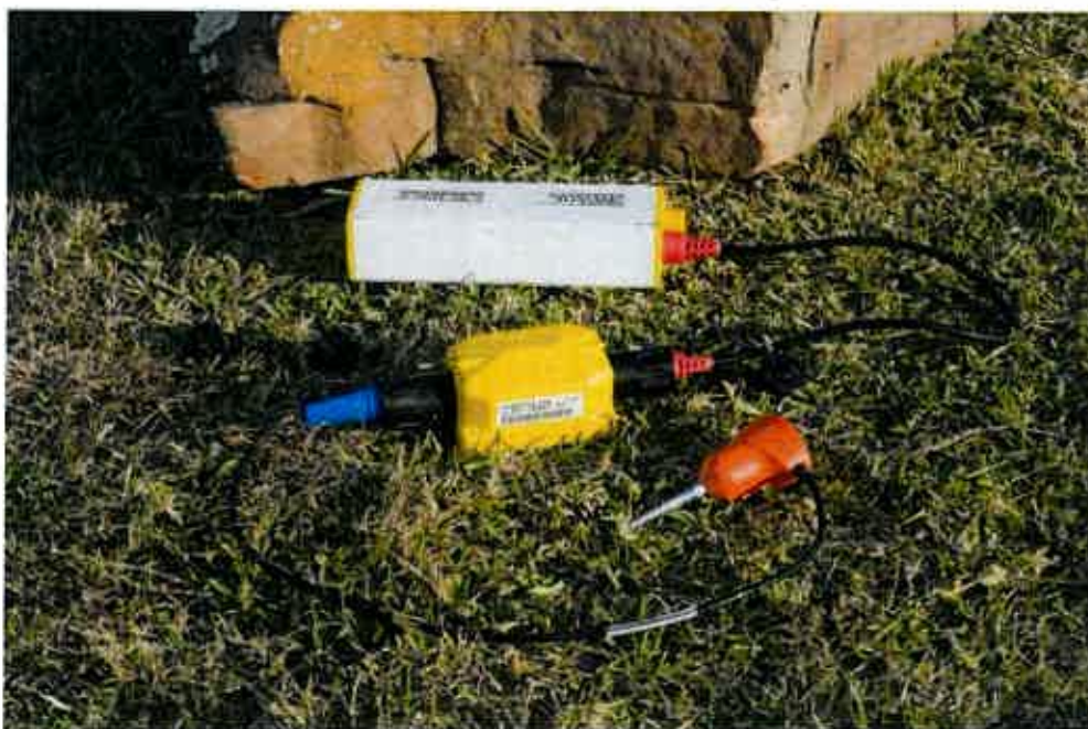
Kihelyezett terepi mérőpont, geofon és adatgyűjtő elektronika
