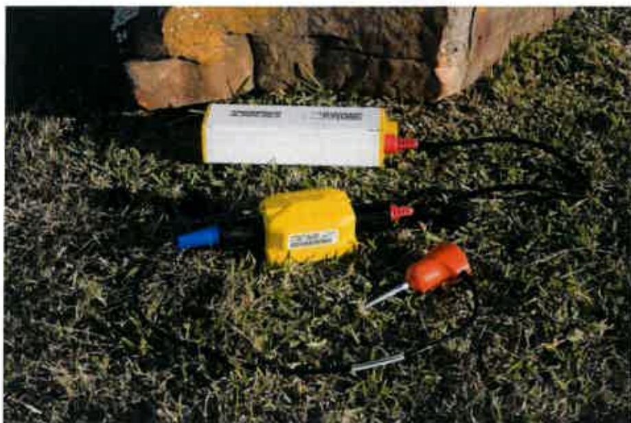
Kihelyezett terepi mérőpont, geofon és adatgyűjtő elektronika
